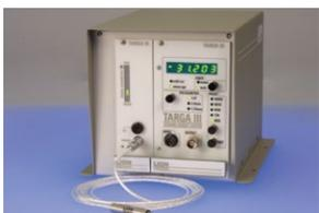
Targa III はさまざまな速度でスピンドルの振れ (ウォブル) を測定し、最適な運転速度とリビルドする時点を把握することができます。
