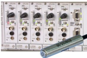
静電容量センサは、導電性のターゲットの位置または位置変化を-高分解能で測定できる非接触式デバイスです。静電容量センサは、非常に高い分解能を持っていますが、清潔な動作環境を必要とします。また、このセンサは、絶縁性のターゲットの位置やその他特性を測定することもできます。
