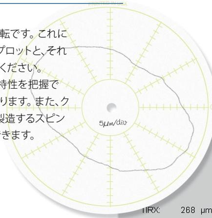
穴の真円度プロットと、それを切削するスピンドルのエラー動作。
