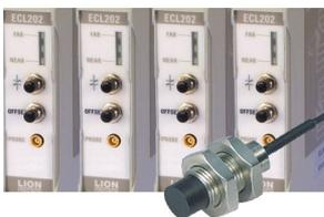
渦電流センサ (誘導センサとも呼ばれる) は、導電性のターゲットの位置または位置変化を高分解能で測定できる非接触式デバイスです。渦電流センサの分解能は静電容量センサほど高くはありませんが、濡れて汚れている環境で使用することができます。
